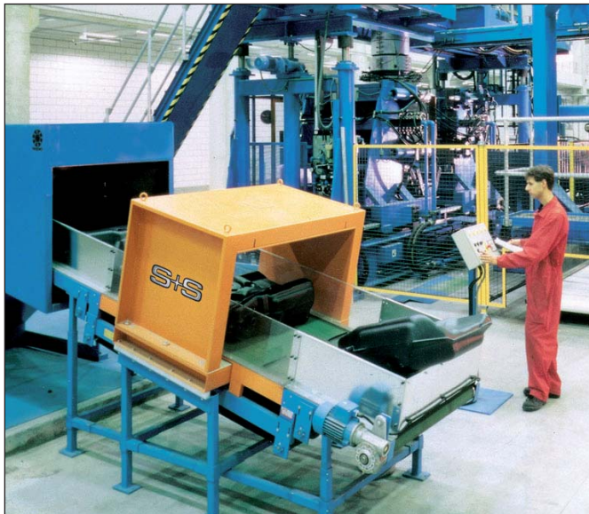
Tunnel-Metall-Detektor DLS bei der Untersuchung von Kunststoff-Tanks
